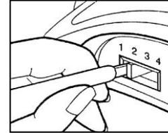
Führt keine dieser Einstellungen zum Erfolg, verwenden Sie wahrscheinlich einen Handhörer mit einem dynamischen Mikrofon. Schieben Sie den rechten der beiden DIP-Schalter (11) auf „OFF“ und stellen Sie die Kompatibilität mit dem Schiebeschalter (10) wie zuvor beschrieben her.
